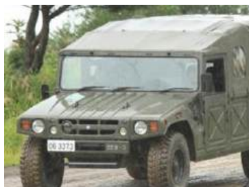
【自衛隊 高機動車】 車高、車幅ともにひとまわり大きな 人員・物資輸送車両。
